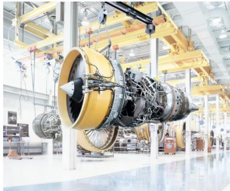
*Figura 2.2 - Motore per jet di GE – CF34; FONTE: (GEaerospace, s.d.)*
