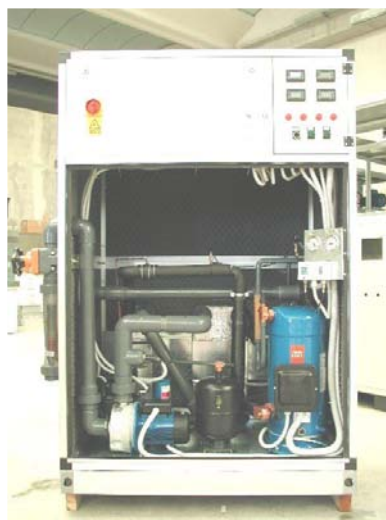
Figura 5.3: Sistema di recupero di calore dell'acqua di ricambio: impianto reale
