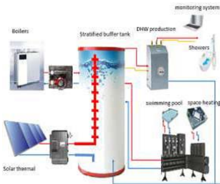
Figura 5.12: Principio di funzionamento di un puffer stratificato
