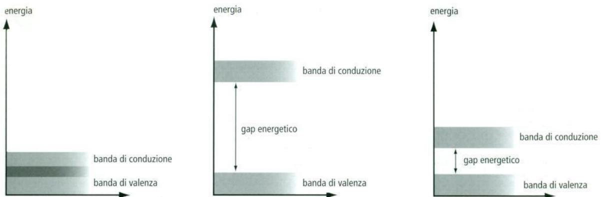
Figura 1.2 : Banda di valenza e di conduzione rispettivamente in un materiale conduttore, isolante, semiconduttore.
