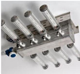
Figura 5.2 : Apparecchio a fonti plurime per l'illuminazione di gallerie formato da otto elementi cilindrici in vetro al borosilicato con all'interno le piastre LED e i dissipatori termici. Gli elementi sono orientabili verso le pareti della galleria. Contengono moduli da sei LED con flusso luminoso 4688 lm (a 500 mA di corrente di pilotaggio) e 3250 lm (a 360 mA), potenza complessiva 60W (a 360 mA), temperatura di colore 5600 K.
