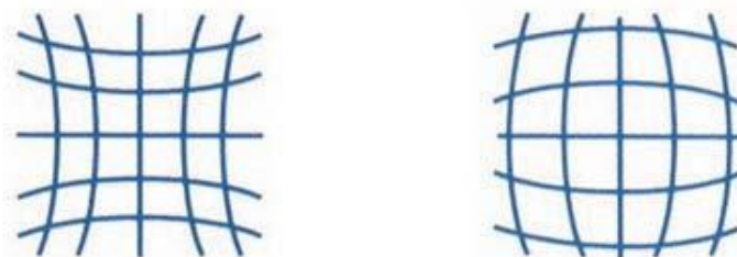
Figura 2.10 – Le due tipologie di distorsione radiale: a cuscino (a sinistra) e a barile (a destra)
