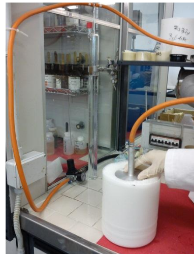
Figura 3.1. Manometro ad acqua per la misurazione dell'ostruzione al passaggio d'aria
