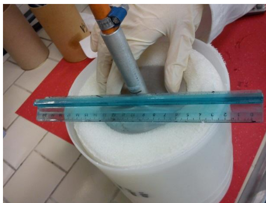
Figura 4.1. Misurazione della resistenza al passaggio d'aria con il manometro ad acqua
