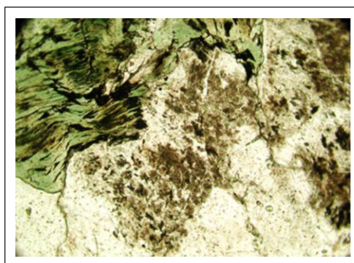
Fig. 2.8 – Grossi cristalli di k -feldspato caolinizzati e biotite fortemente alterata e deformata “Kinking” (ingrandimento 10X, nicol paralleli)
