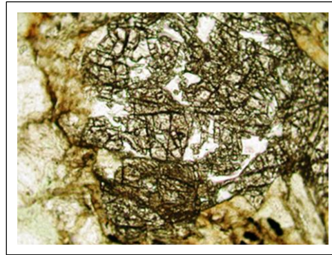
Fig. 2.11 – Cristallo di granato molto fratturato (ingr. 10X, nicol paralleli)
