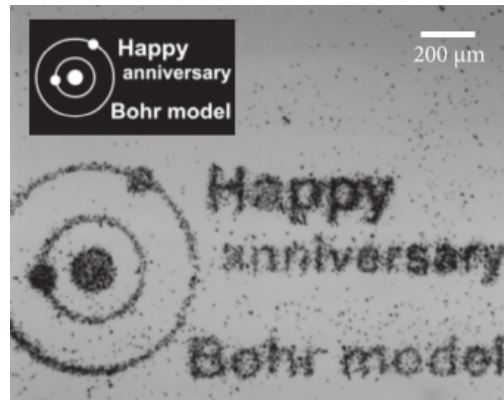
Figura 2.13: Intrappolamento per elettroforesi su di un campione di niobato di litio Z-cut. La foto mostra come le particelle cariche vadano a posizionarsi, senza alcuna anisotropia, nelle regioni precedente illuminate secondo il pattern riportato nel quadrato nero.
