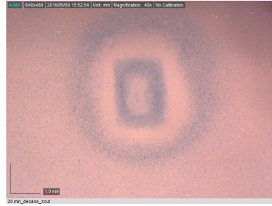
Figura 4.5: Intrappolamento per dielettroforesi di particelle di carbone in decano (3 mg/ml). Campione 190.21 faccia Z+, potenza di scrittura P = 0.87 mW. Tempo di scrittura 20 minuti.
