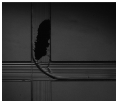
Figura 5.9: Agglomerato di particelle di toner all'interno del canale microfluidico del chip utilizzato per le prove di intrappolamento. I canali aperti ed utilizzabili sono quello verticale superiore e quello orizzontale di destra. Gli altri due sono pieni di NOA il cui menisco concavo è visibile nel centro dell'incrocio tra i bracci.
