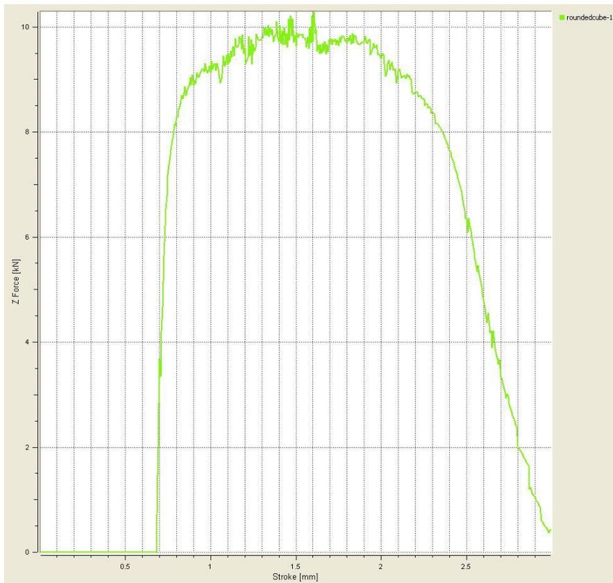
**Figura 43** Curva della forza su corsa risultante dalla simulazione 2D
