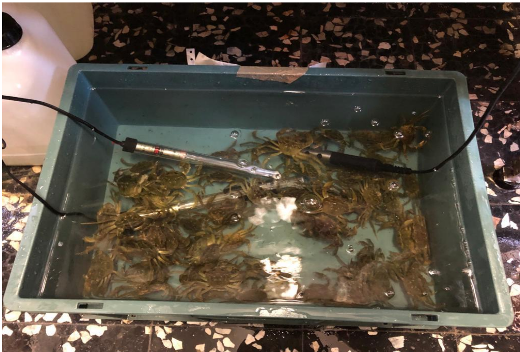
Figura 2. Attrezzatura sperimentale per il trattamento termico, a destra si può vedere la sonda multiparametrica, a sinistra due riscaldatori. Nella vasca si possono vedere gli organismi, mentre gli aeratori sono stati tolti per scattare la foto.
