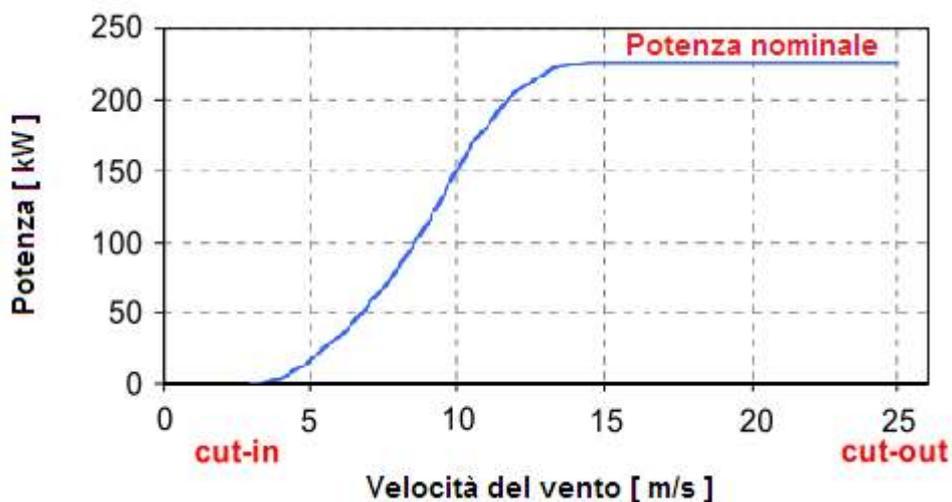
Fig.2.5: andamento della produzione di energia di una turbina eolica in relazione alla velocità del vento
