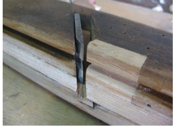
Fig. 2.4 - Particolare del ferro di una pialla per la realizzazione dei soli incastri maschi.
