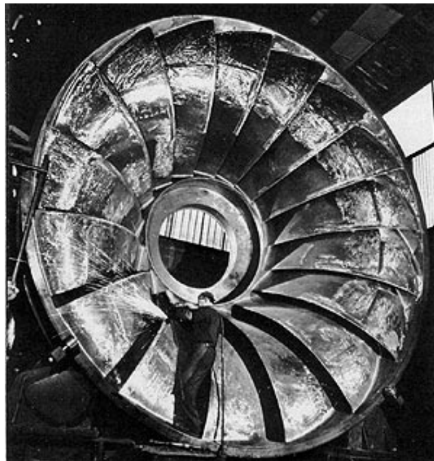
Figura 1.7: Tipica girante di una turbina Francis
