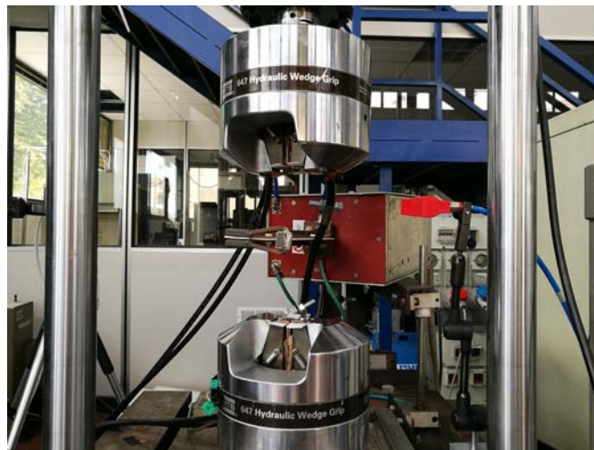
Figura 2.5: Vista delle griffe della pressa MTS e della testa di riscaldamento dell'induttore
