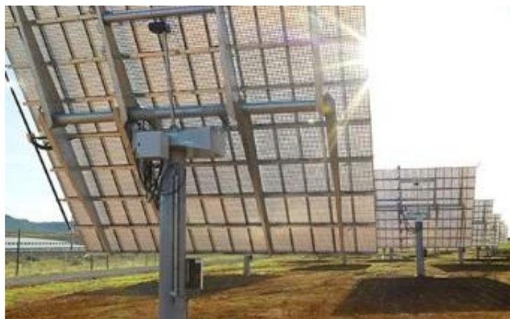
*Figura 19 Sistema di tracking a due assi*
