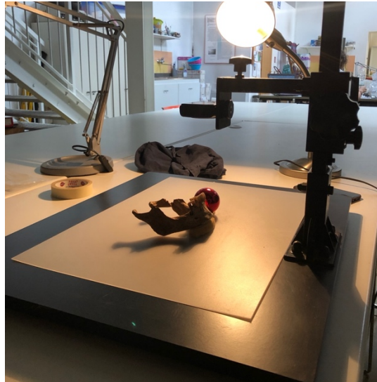
Fig. 27: acquisizione delle fotografie utilizzando una semplice lampada da scrivania (spostata manualmente), una sfera riflettente, un sostegno per la macchina fotografica Canon IXUS 285 HS.
