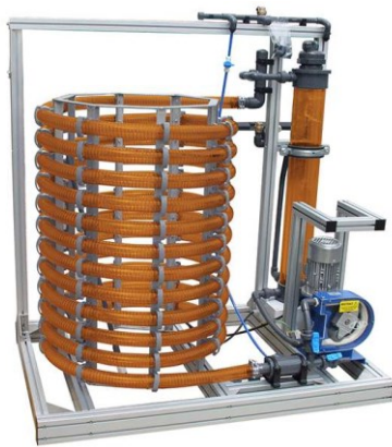
Figura 11. Fotobioreattore a colonna verticale
