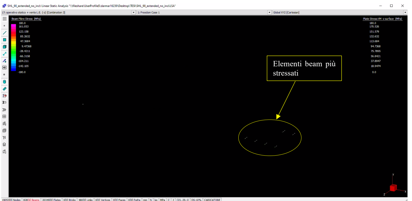
Figura 5.1.7: Andando ad evidenziare solo gli elementi più critici si nota che questi sono parte solamente delle passerelle
