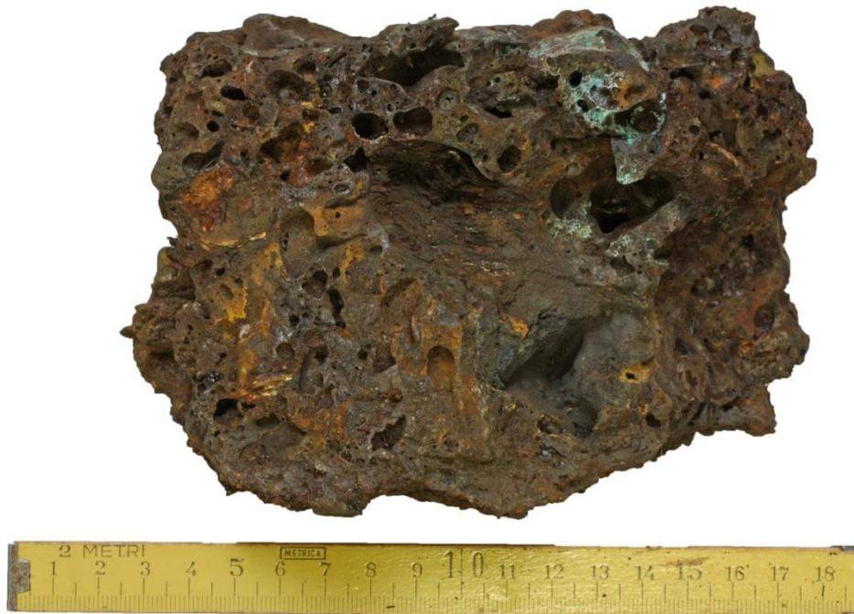
**Figura 11.** Una scoria grossolana proveniente dallo scavo. Si noti l'elevata porosità e le patine di ossidi-idrossidi di Fe (color ocra) e di minerali secondari di Cu (di colore verde-azzurro).
