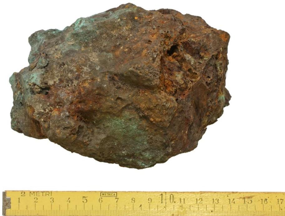
**Figura 12.** Una scoria massiccia proveniente dallo scavo. Si noti la ridotta porosità e le patine di minerali di Cu e di Fe.
