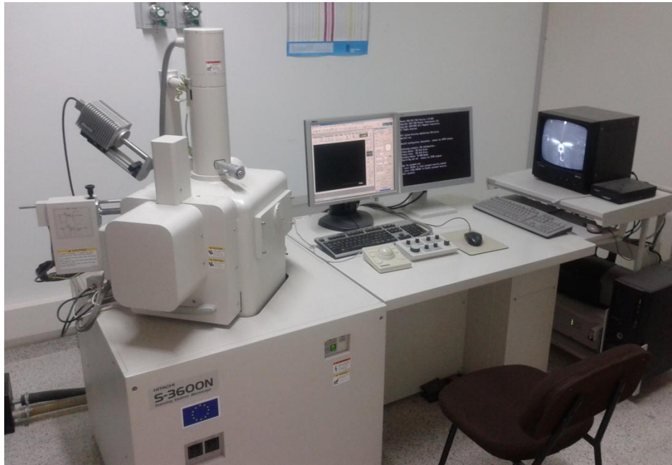
Figura 4.5 Microscopio elettronico a pressione variabile (S-3600, Hitachi, Japón)
