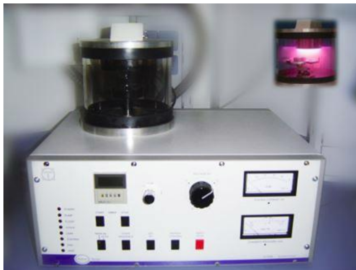
Figura 4.6 Schema della preparazione dei campioni per la loro osservazione (sopra) e strumentazione per la metallizzazione degli stessi(sotto), SC7640 Sputter Coater.
