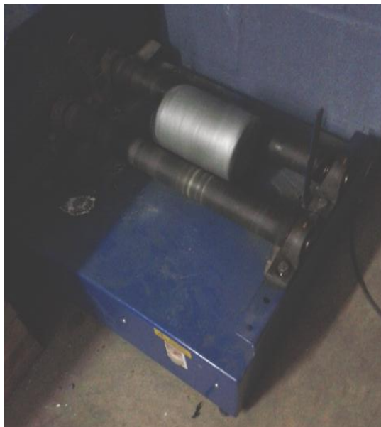
Figura 2.4 Miscelazione e Omogeneizzazione per 24 ore con metanolo e palle di nitruro di silicio.
