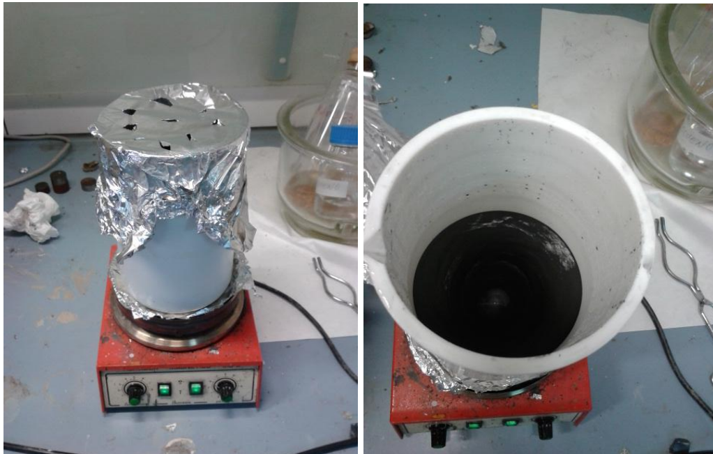
Figura 2.5 Evaporazione del metanolo nel contenitore di teflón sulla piastra riscaldante.
