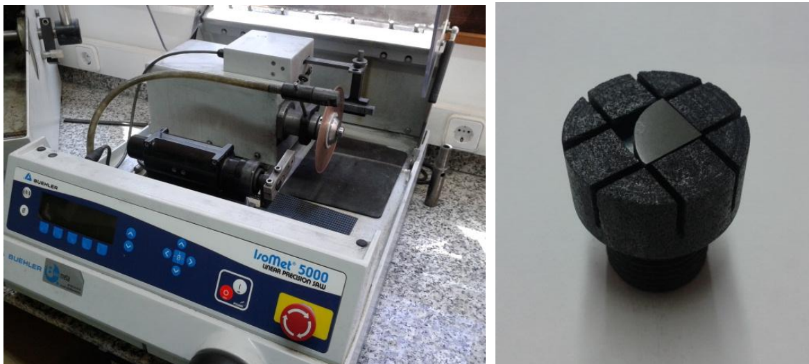
Figura 2.15 Macchina usata per il taglio (sinistra) e campione collocato nel porta campione di grafite (destra).
