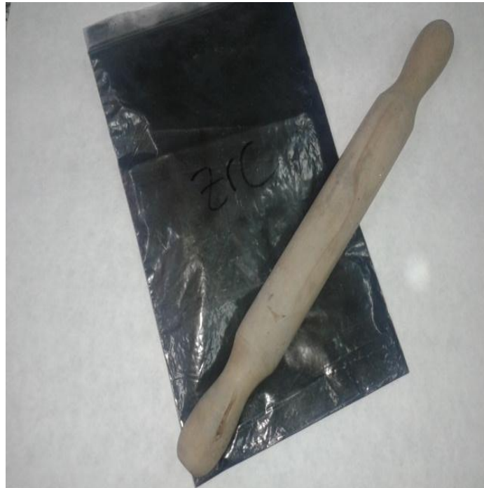
Figura 2.6 Disagglomerazione dei grani di polvere seccata.
