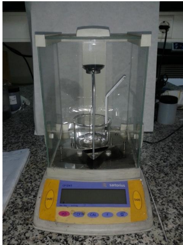
Figura 4.1 Bilancia analitica di precisione e accessori utilizzati per la misurazione della densità.
