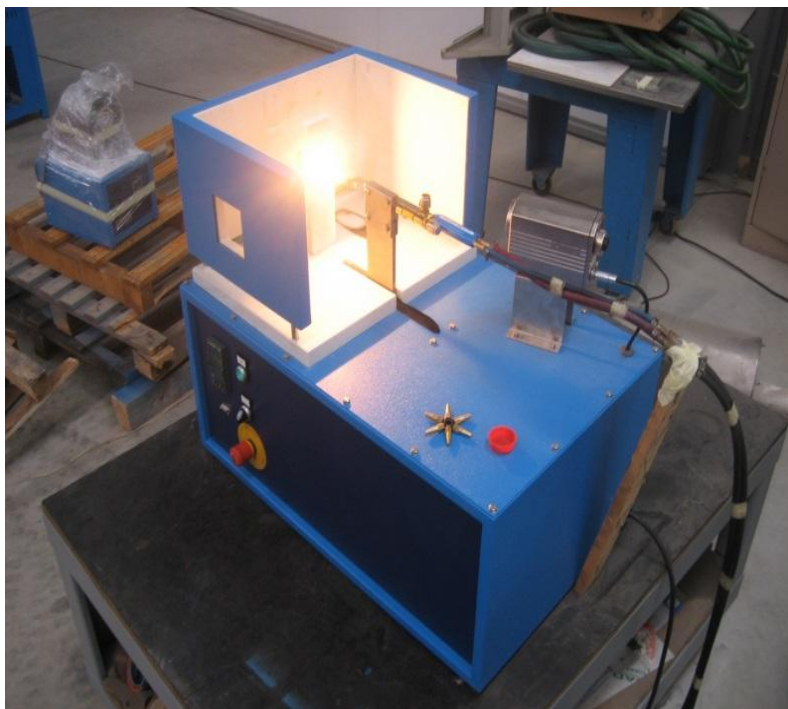
Figura 3.2 Macchinario per le prove di ablazione con fiamma in funzione.
