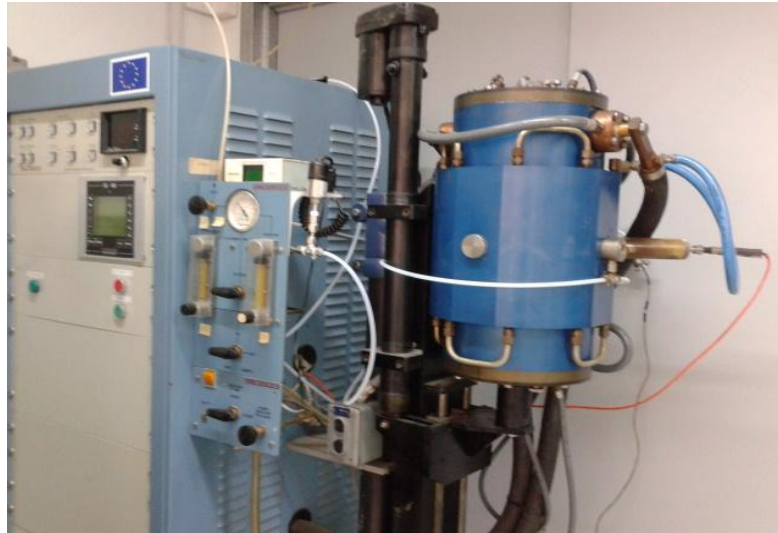
Figura 2.11 Forno per alte temperature con atmosfera controllata.
