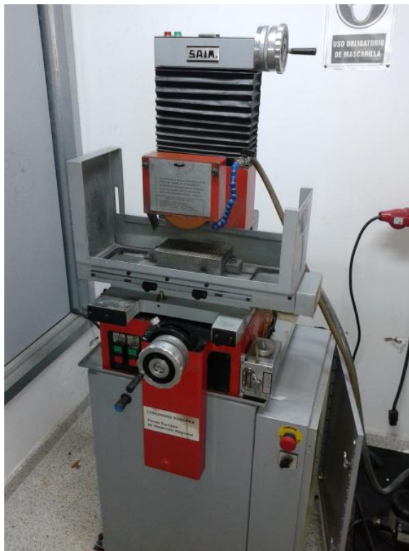
Figura 2.13 Rettificatrice (mod. 220 – 2H, SAIM Metal S.L., España)
