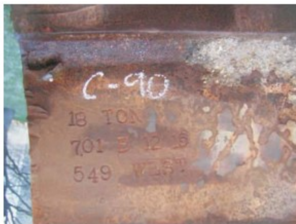
Figura 3.17. Codici identificativi rinvenuti sulla porzione inferiore di una colonna del nucleo interno appartenente al WTC 2 (S.W. Banovic, T. Foecke, and F.W. Gayle (2006), Assessment of Structural Steel from the World Trade Center Towers, Part I: Recovery and Identification of Critical Structural Elements ).
