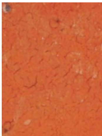
Figura 3.40. Quadro fessurativo sullo strato di vernice di primer in seguito all'esposizione di due ore alla temperatura di 250°C (S.W. Banovic, T. Foecke (2006), Assessment of Structural Steel from the World Trade Center Towers, Part IV: Experimental Techniques to Assess Possible Exposure to High-Temperature Excursions).
