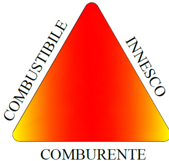
Figura 1.1. Schematizzazione del fenomeno di incendio tramite triangolo del fuoco
