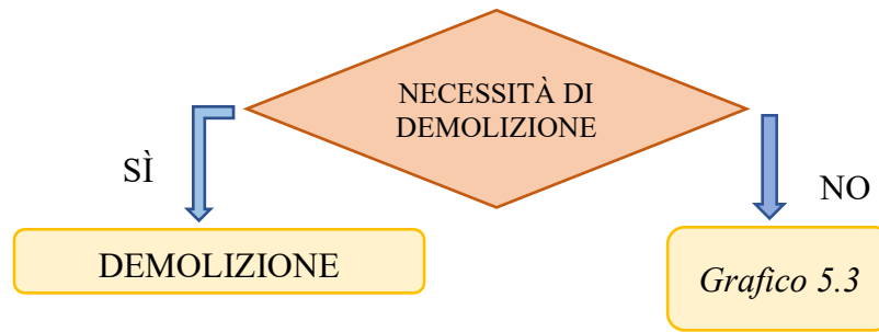
Grafico 5.2. Diagramma di flusso relativo alla prima parte della strategia valutativa di intervento su una struttura esposta all'azione del fuoco.
