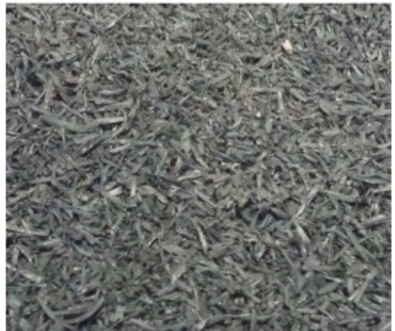
Figura 4.1 Fibre di gomma utilizzate proveniente da diversi produttori, ottenuta principalmente da raspatura, si presenta con tipologie, densità e pezzatura differenti.
