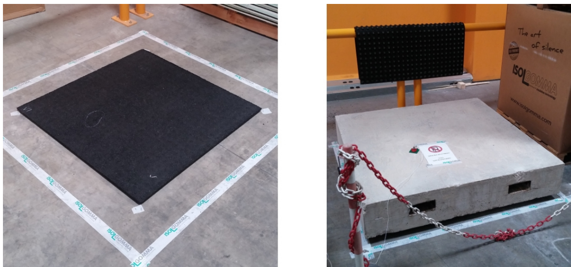
Figura 6.19 Materassino e piastra armata utilizzata per le misure creep .
