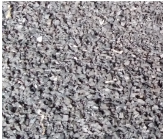
Figura 4.2 Gomma in granuli di gomma o di inerti espansi.
