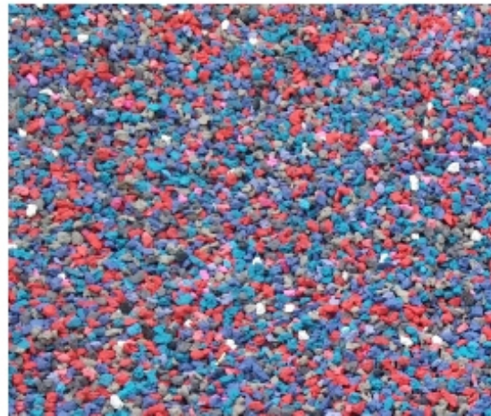
Figura 4.2 Gomma in granuli di gomma o di inerti espansi.
