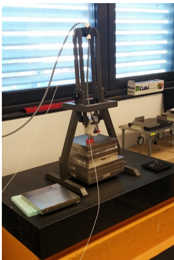
Figura 6.1 Misurazione dell'andamento della frequenza naturale su un provino
