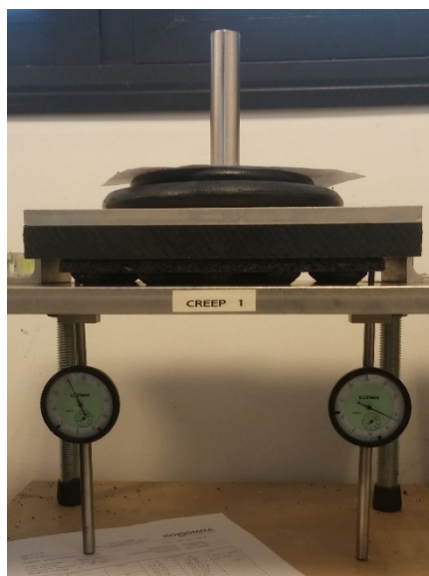
Figura 4.11 Dispositivo per la rilevazione dei cedimenti nel tempo dei materiali utilizzati come sottofondi in pavimenti galleggianti.
