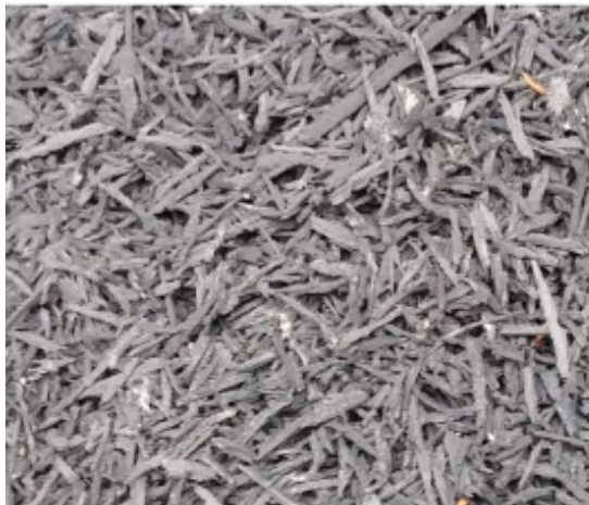
Figura 4.1 Fibre di gomma utilizzate proveniente da diversi produttori, ottenuta principalmente da raspatura, si presenta con tipologie, densità e pezzatura differenti.
