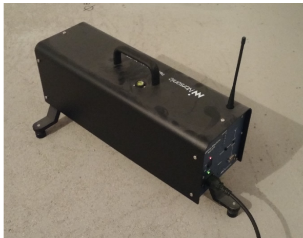
Figura 5.6 Generatore di calpestio normalizzato secondo le caratteristiche richieste dalla normativa ISO, dotato di radiocomando.
