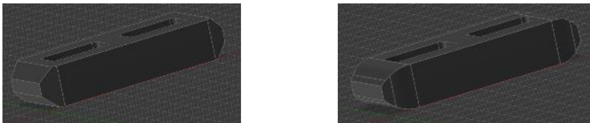
Figura 4.14: Schermate di Fusion 360 con l'evoluzione del solido 3D: a sinistra dopo la generazione dello smusso trapezoidale e a destra post comando “Chamfer” con i quattro smussi curvi per terminale.
