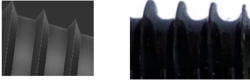
Figura 4.7: Particolare delle creste sulla vite 1L PLUS: a sinistra la riproduzione virtuale con la sezione triangolare del profilo della filettatura e a destra il profilo della filettatura reale con sezione quasi iperbolica.
