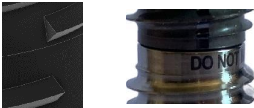
Figura 4.8: Particolare del principio della filettatura sulle due ancore: a sinistra la riproduzione virtuale che si interrompe bruscamente e a destra il principio che sparisce con l'avanzare della filettatura.
