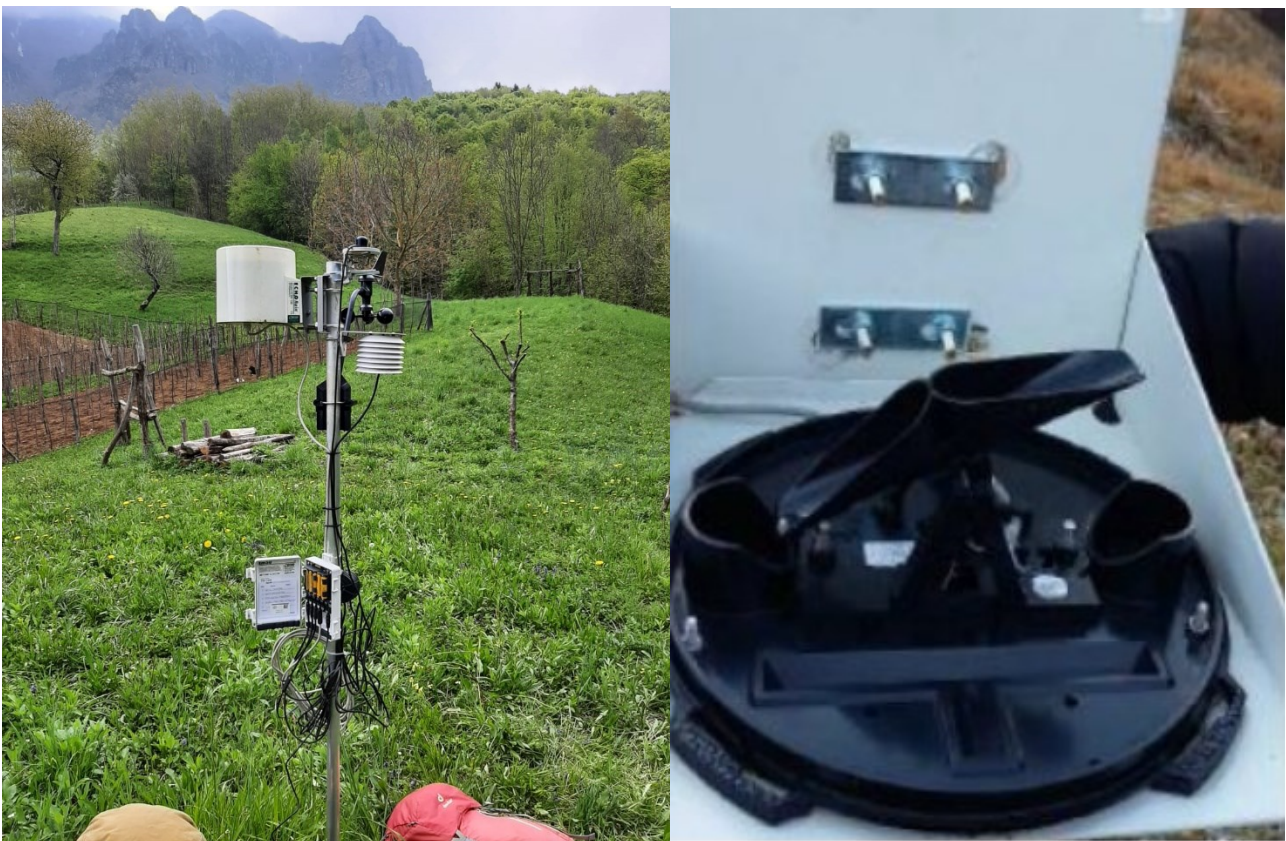
Figura 3.2.1: Stazione meteorologica (a sinistra) e sistema basculante del pluviometro (a destra) presenti nell'area sperimentale di Rio Ressi.
