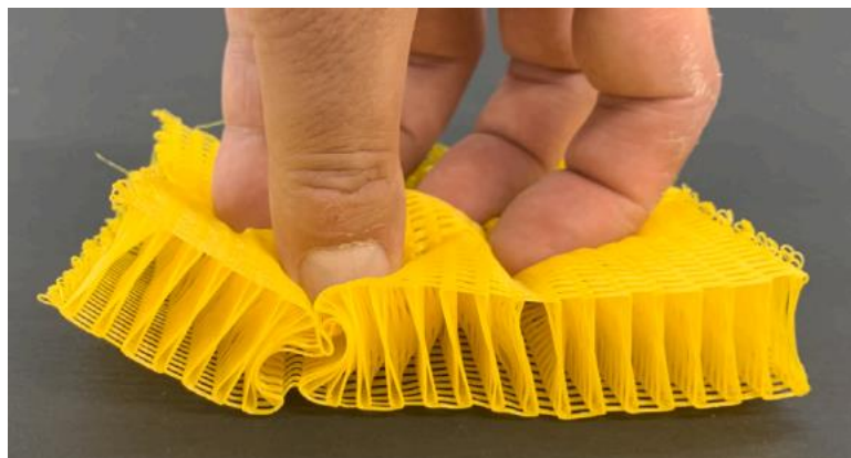
Figura 8. Tessuto distanziatore stampato in 3D in uno stato di compressione (Halbrecht et al., 2023, pp.2)
