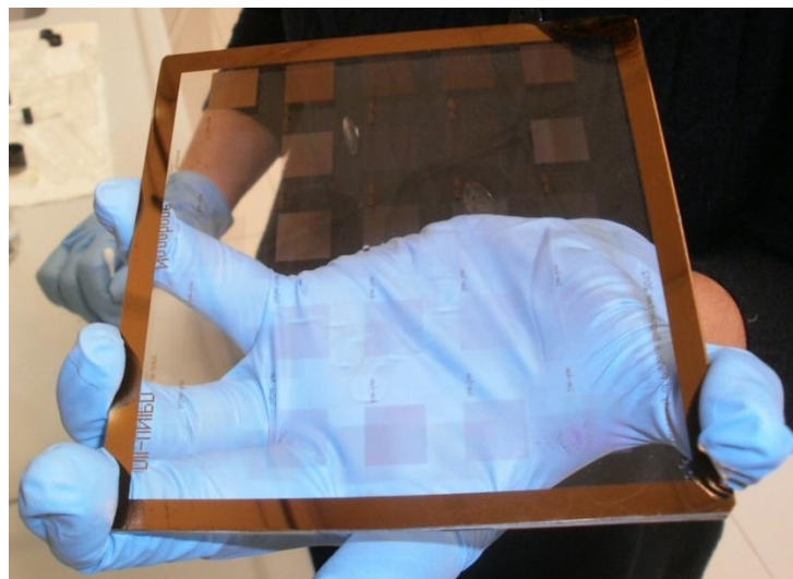
Figura 34 - Maschera per fotolitografia a contatto
