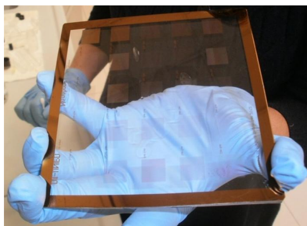
Figura 44 - Maschera per fotolitografia a contatto
