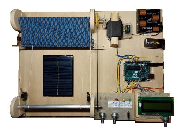
Usando la scheda Arduino Uno si comanda il sistema di protezione. I segnali d'ingresso sono associati a sensori che identificano il maltempo, le uscite pilotano motore, monitor e led. Al motore è collegato il telo di protezione Led e monitor danno delle informazioni sullo stato dell'impianto.
