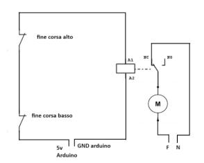
Per una protezione ulteriore del sistema di avvolgimento del telaio si usa un circuito secondario con la logica del 'positivo a mancare':
