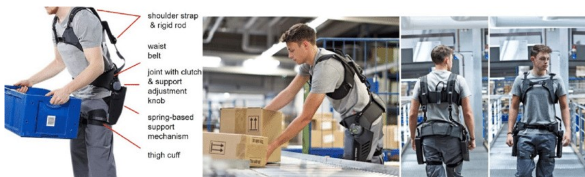
Figura 6: Esoscheletro Ottobock Paexo Back. A sinistra sono descritti i componenti del dispositivo; in centro ed a destra sono riportati esempi di utilizzo [10].
