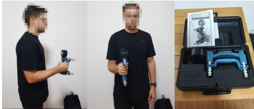
Figura 7: Handgrip Test. Da sinistra viene raffigurata l'esecuzione del test vista dal piano laterale e frontale; infine viene riportato il dinamometro idraulico utilizzato.
