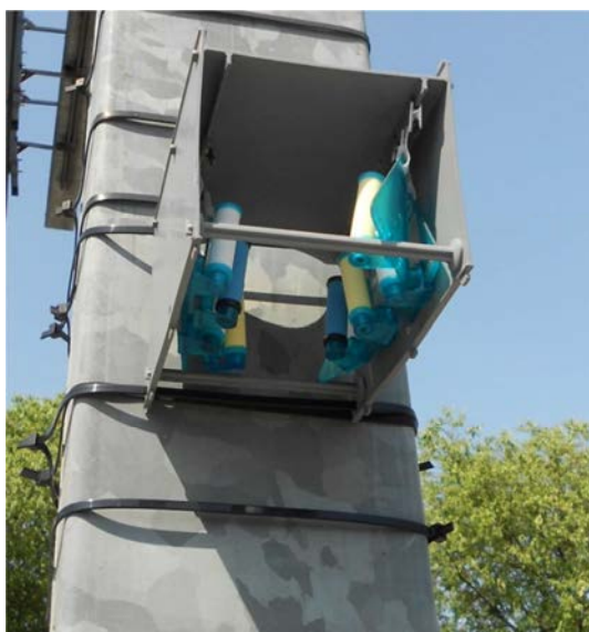
Figura 3.1 - Campionatori posizionati all'interno dei box situati in C.so Stati Uniti a Padova.
