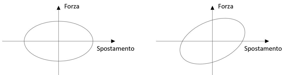
Figura 4-9: ciclo di isteresi dei dissipatori viscosi: puramente viscoso e visco-elastico.
