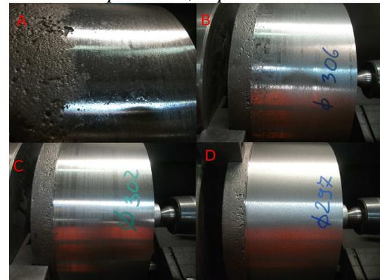
Figura 4.6: Lavorazione meccanica del provino 1: A:Diametro 310 mm, B:diametro 306 mm, C:diametro302 mm, D:diametro297mm
