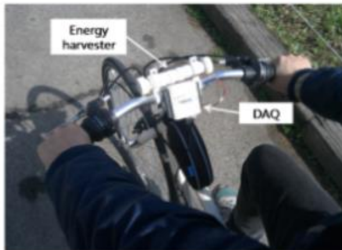
Figura 3.24: Posizionamento dell'harvester sulla bicicletta [14]
