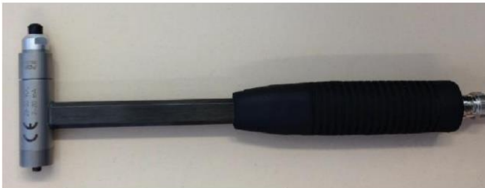
Figura 7.6: Martello strumentato per esercitare l'accelerazione impulsiva alla barra
