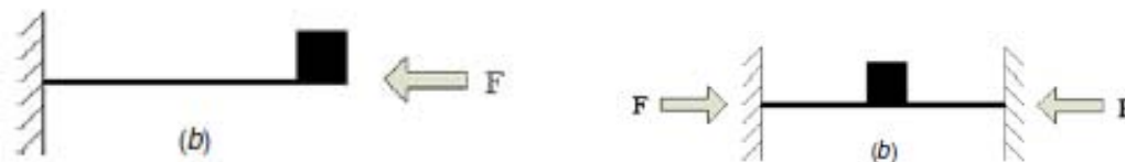
Figura 6.3: Pre-carico del cantilever con forze concentrate [21]
