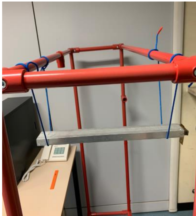
Figura 7.2: Supporto metallico della barra
