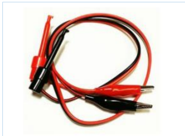
Figura 7.4: Cavo per la misura della tensione generata dall'harvester
