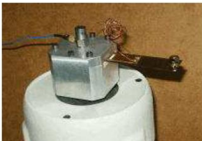
Figura 3.7: Shaker meccanico per l'eccitazione dell'harvester [11]
