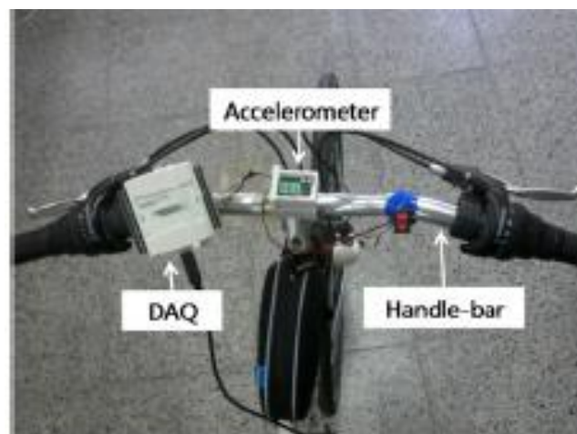
Figura 3.18: Posizionamento degli strumenti di misura sulla bicicletta [14]
