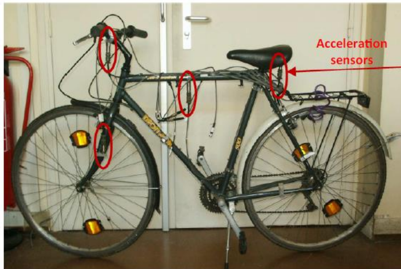
Figura 3.1: Posizionamento accelerometri sulla bicicletta [11]
