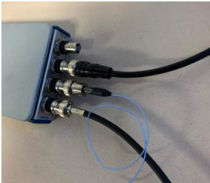
Figura 7.9: Posizione dei cavi nel modulo di acquisizione
