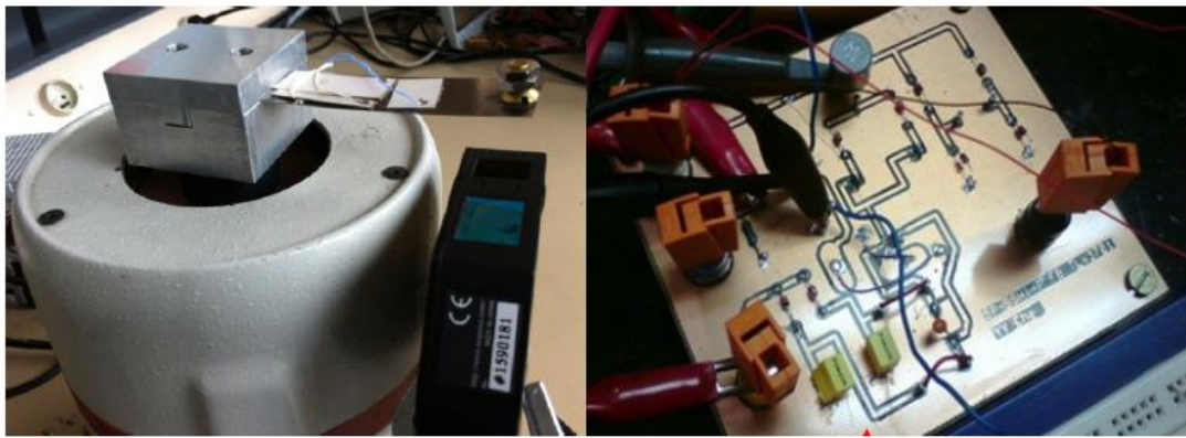
Figura 3.14: Shaker meccanico connesso al sistema di switching [12]
