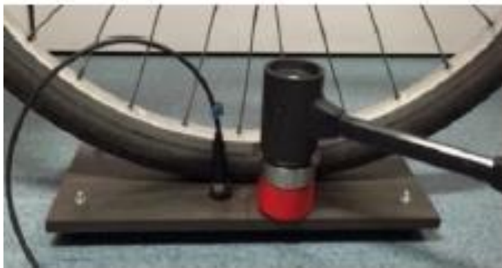
Figura 4.2: Martello strumentato per imprimere gli impulsi sulla ruota [16]
