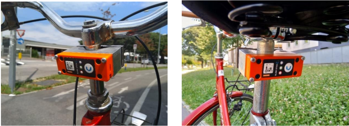
Figura 4.5: Accelerometro posizionato sotto il manubrio (a) e sotto la sella (b) della bicicletta su strada [16]
