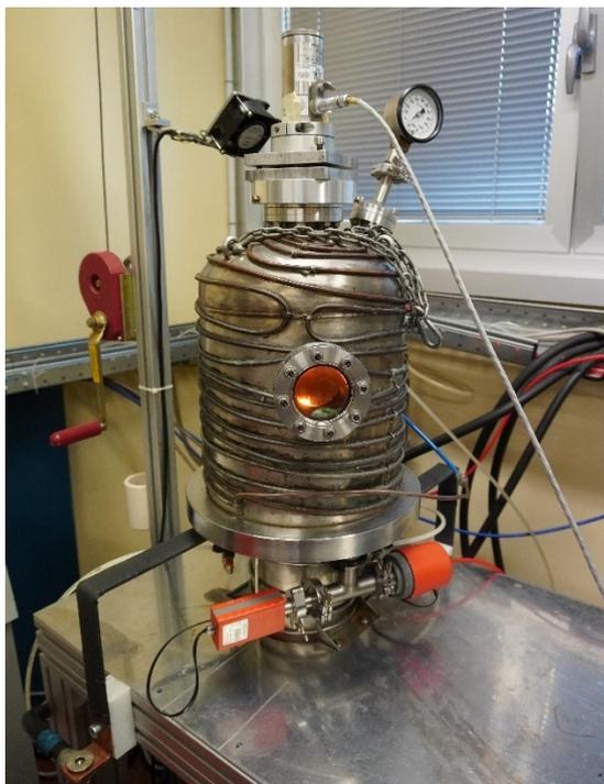
Figura 3.6 - Camera per il vuoto; si nota la serpentina del circuito di raffreddamento che la percorre
