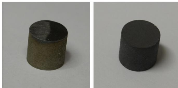
Figura 4.8 - Provino riscaldato a 600°C: prima (a sinistra) e dopo (a destra)
