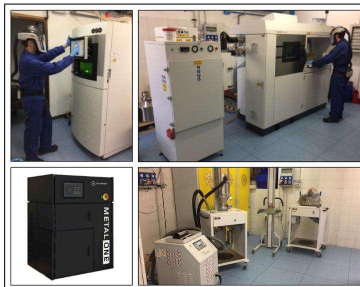
Figura 2.15 - I tre macchinari di *Selective Laser Melting* e i sistemi ausiliari presenti al *DIAM* di Padova
