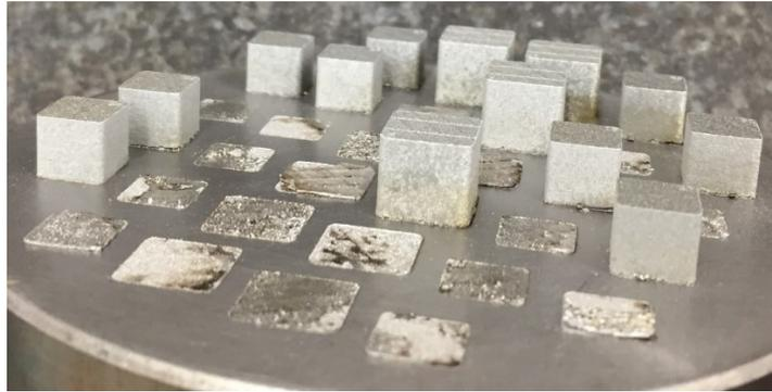
Figura 2.18 - 36 provini dopo il primo step di ottimizzazione dei parametri
