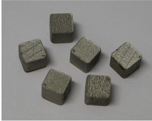
Figura 3.21 - Cubetti di Mo AM utilizzati per la stima della temperatura limite di sublimazione
