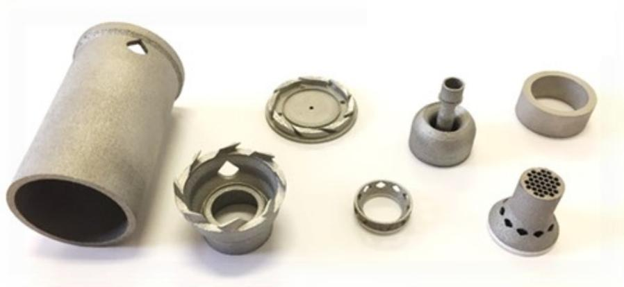
Figura 2.27 - Prototipi realizzati in AlSi10Mg tramite SLM
