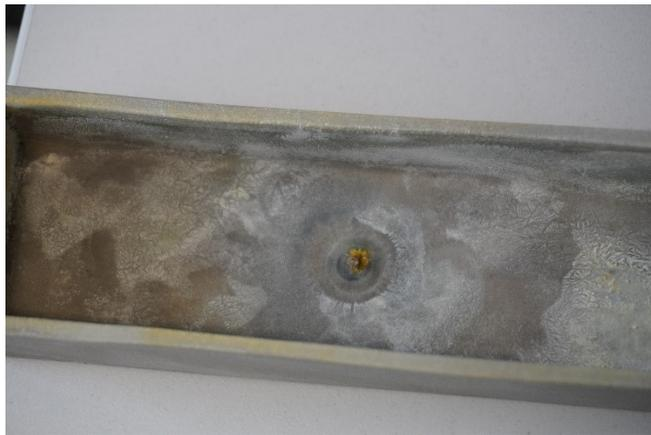
Figura 4.10 - Il provino portato a 1000°C completamente evaporato
