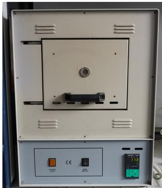
Figura 4.5 - Forno elettrico a muffola presente nel laboratorio di chimica dei LNL
