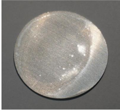
Figura 3.10 - Provino 2 AM dopo i riscaldamenti, sul quale si possono notare i grani ricristallizzati
