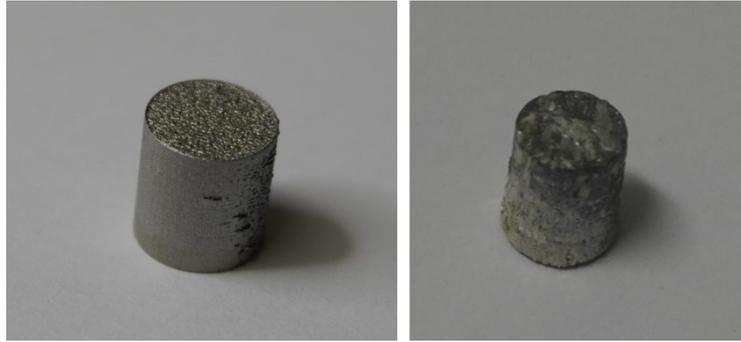
Figura 4.9 - Provino riscaldato a 800°C: prima (a sinistra) e dopo (a destra)
