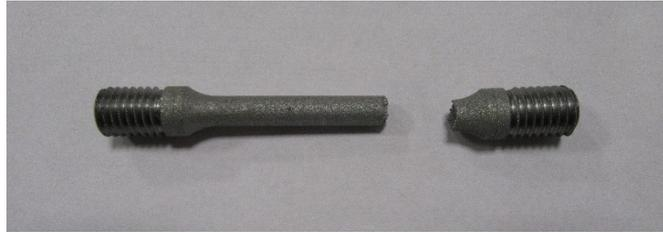
Figura 4.13 - Provino rotto dopo la prova a RT
