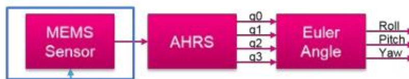
Figura 22 Modulo contenente i dati dei sensori
