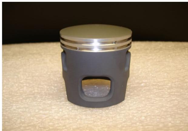
Nonostante l'allumina sia un materiale fragile, il rivestimento ottenuto ha spessore molto inferiore allo spessore totale del mantello e pertanto ricopre un ruolo meccanico esclusivamente di indurimento superficiale, pertanto antiusura e antifrizione.
