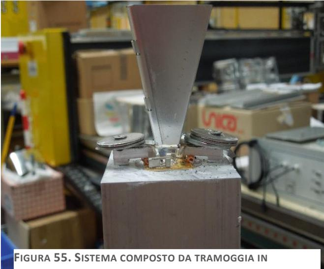
FIGURA 55. SISTEMA COMPOSTO DA TRAMOGGIA IN ALLUMINIO, PRISMA, CELLA, BLOCCO DI ALLUMINIO PER DISSIPAZIONE.
