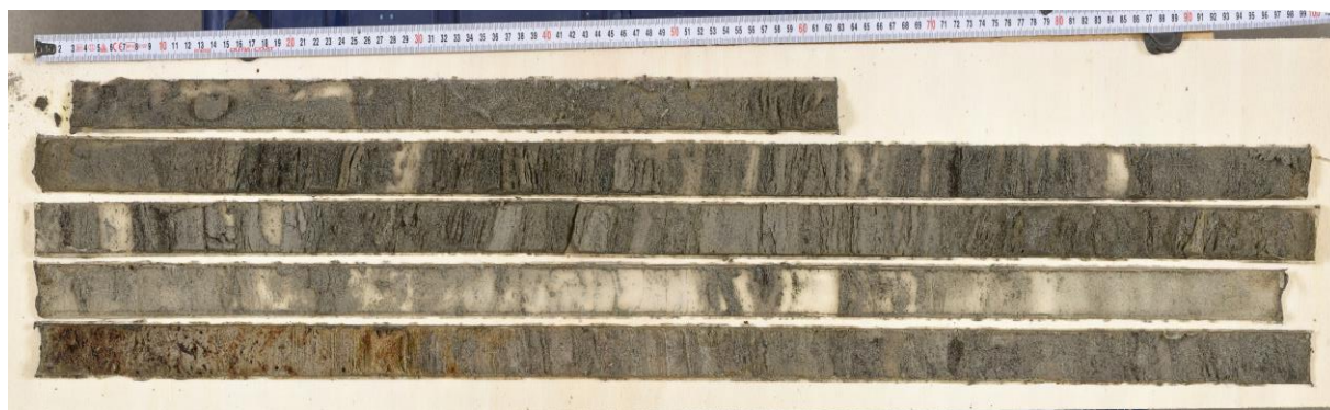
Figura 27: Esempio di come si presenta il carotaggio nella fase finale di preparazione per la fase di riconoscimento dei depositi, in foto il sondaggio "1"
