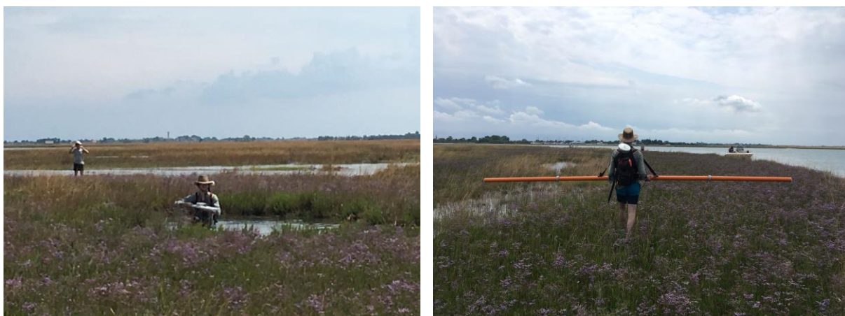
Figura 16: a sinistra) Acquisizione dei dati tramite sensore elettromagnetico GEM-2; a destra) Acquisizione dei dati tramite sensore elettromagnetico CMD-Explorer
