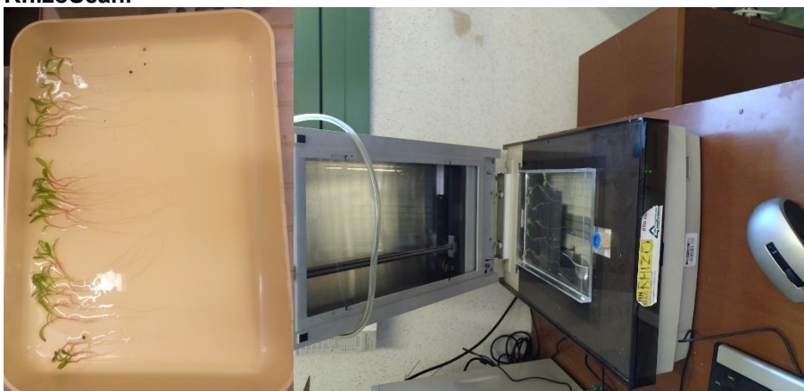
Foto 3.8: Estrazione, scansione e analisi parametri con scanner WinRHIZO e programma RhizoScan.
