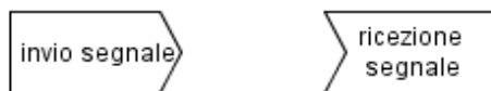
Figura B2- Simboli usati per particolari nodi azione specializzati nell'invio e nella ricezione di segnali
