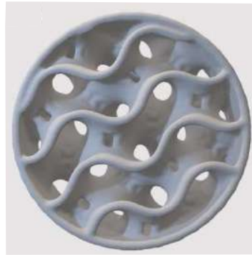
Figura 3.22: Pezzo realizzato con AM da sinterizzare [11]
