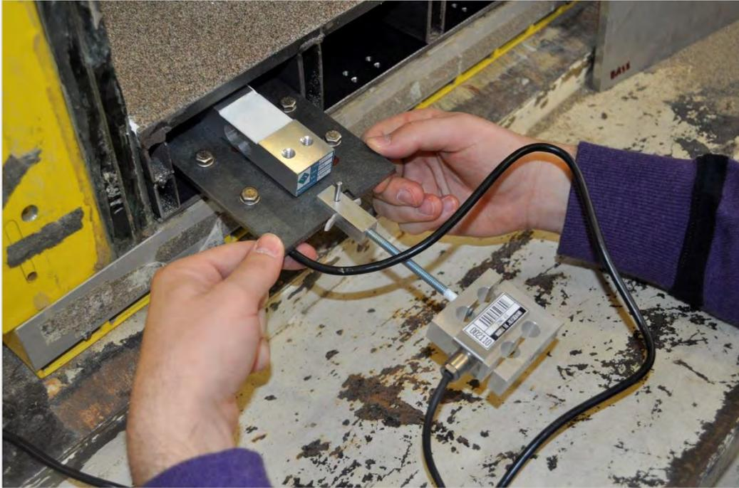
*Figura 5.4 Inserimento sulla rotaia al di sotto del pianale delle celle di carico.*
