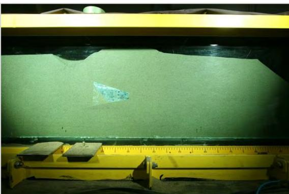
*Figura 7.22 Posizione chiodo a fine estrazione Cono Allungato posizione P2*
