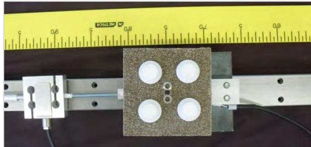
*Figura 5.5 Vista in pianta delle celle di carico con collegata la piastrina di chiusura*
