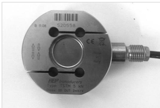
Figura 5.12 Cella di carico a trazione AEP TSTM
