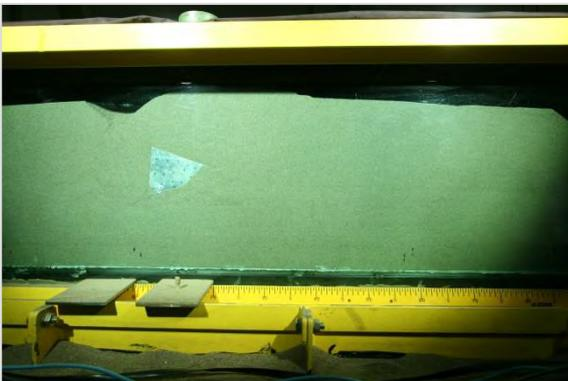
*Figura 7.21 Posizione chiodo a fine estrazione Cono Allungato posizione P1*
