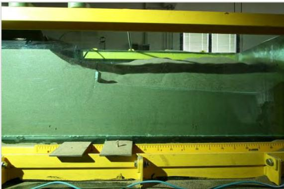
*Figura 7.45 Posizione chiodo a fine estrazione Piastra Piatta posizione P1*
