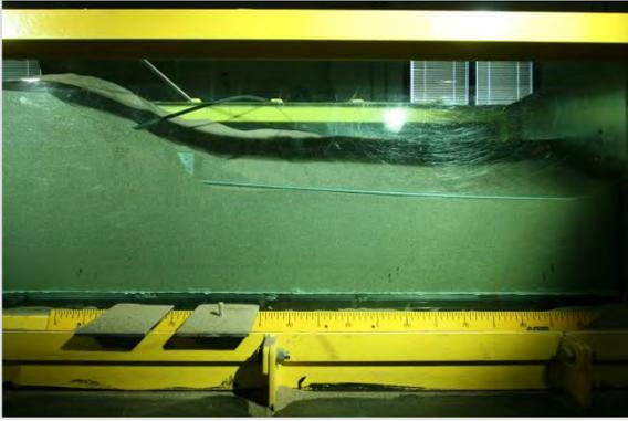
*Figura 7.109 Posizione chiodo a fine estrazione Piastra Piatta Spessa posizione P1*
