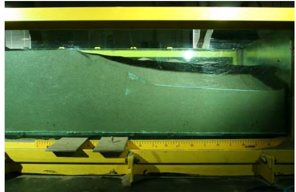
*Figura 7.70 Posizione chiodo a fine estrazione Cono posizione P3*
