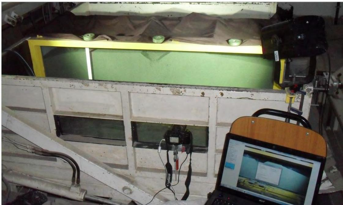
Figura 5.26 Posizione fotocamera sulla sponda del cassone con collegamento al pc per acquisizione foto
