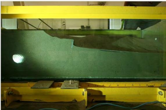
*Figura 7.46 Posizione chiodo a fine estrazione Piastra Piatta posizione P2*
