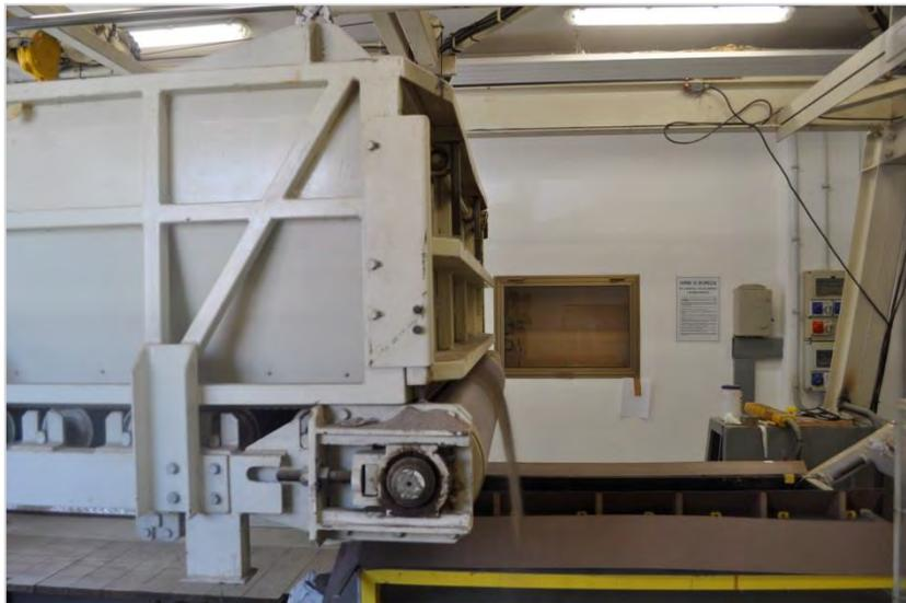
*Figura 5.7 Vista laterale della tramoggia automatica durante la stesa della sabbia*
