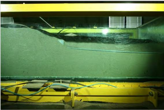
*Figura 7.110 Posizione chiodo a fine estrazione Piastra Piatta Spessa posizione P2*
