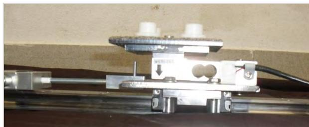
*Figura 5.6 Vista laterale del collegamento tra cella di carico a flessione e piastra di chiusura*
