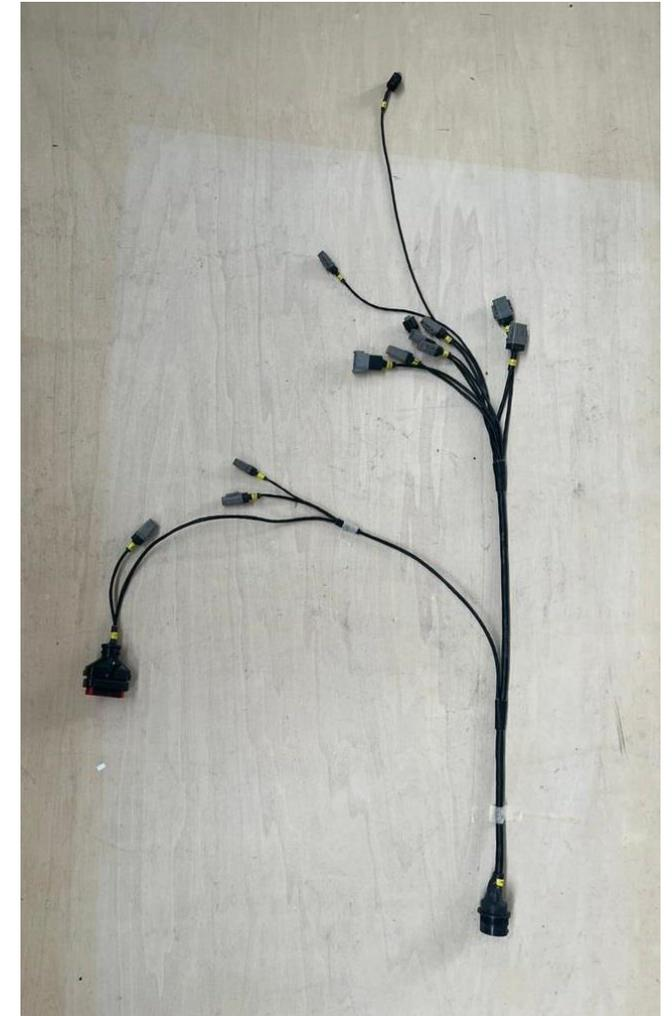
La fase di implementazione consiste nel testare a banco il funzionamento di tutto il cablaggio e la successiva installazione in vettura. Questa fase è stata svolta in sede aziendale sotto la supervisione dei dipendenti che hanno aiutato a risolvere alcuni problemi che sono sorti, in modo particolare con degli ingombri in vettura.
