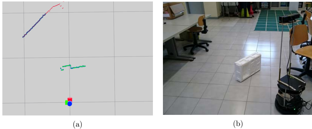
Figura 4.12: Esempio di funzionamento della fusione (azzurro) tra lo scan ottenuto dalla kinect (rosso) e quello ottenuto dal laser (verde). Nella figura di destra è riportata la scena che il robot sta inquadrando.
