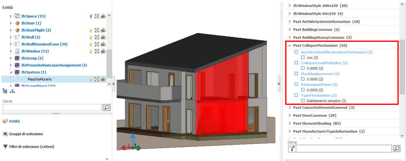
Figura 98 - Implementazione dell'entità IfcSystem e assegnazione del relativo Pset, usBIM.viewer+
