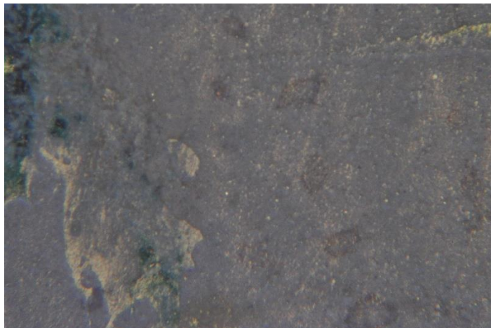
Fig. 4.15 Acciaio pre-verniciato (stessa zona) trattato al plasma, lavato con l'acqua e successivamente strofinato
