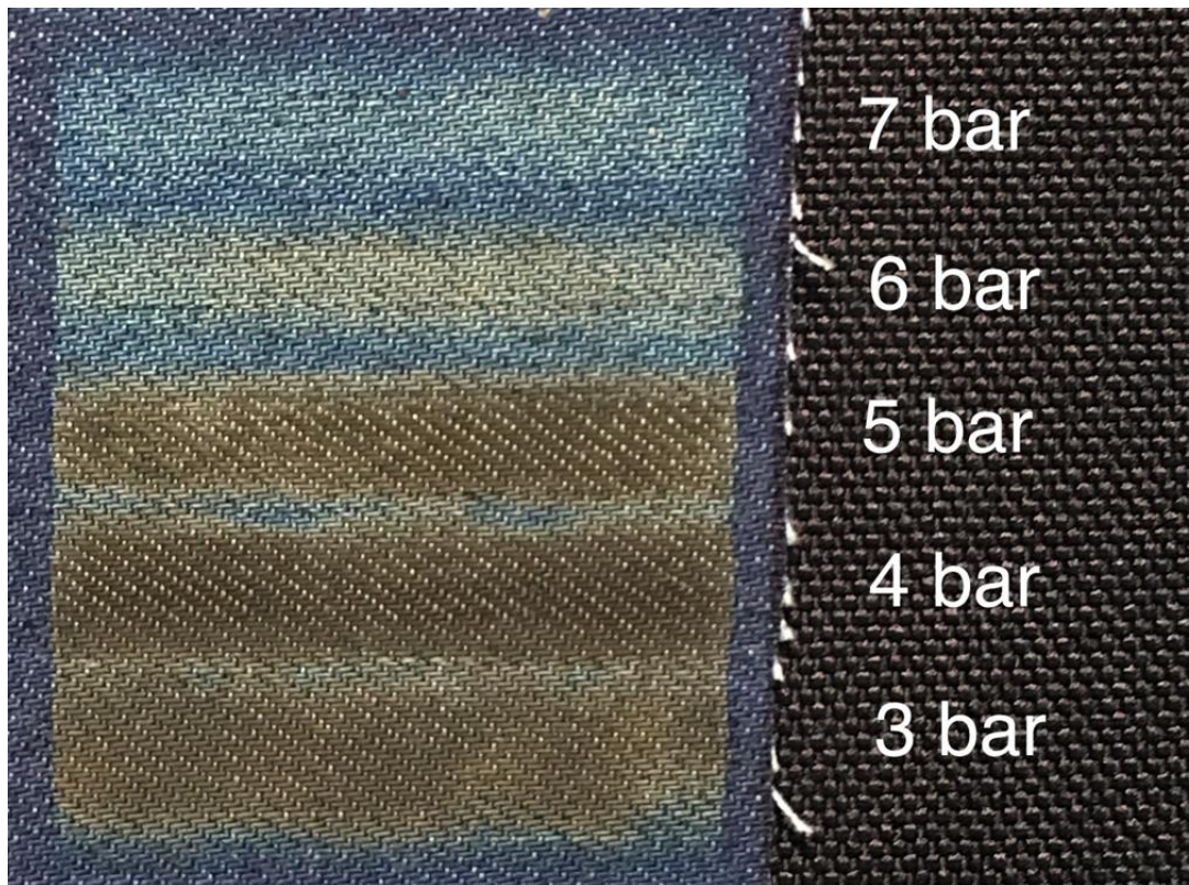
Fig. 4.41 Trattamento su jeans, ugello circolare 4 mm, differenti pressioni d'aria compressa
