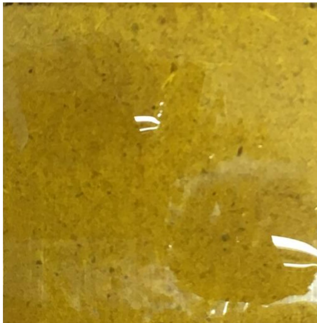
Fig. 4.52 Trattamento su kapton, ugello circolare 2 mm, pressione d'aria compressa =3 bar, 3 minuti dopo il trattamento
