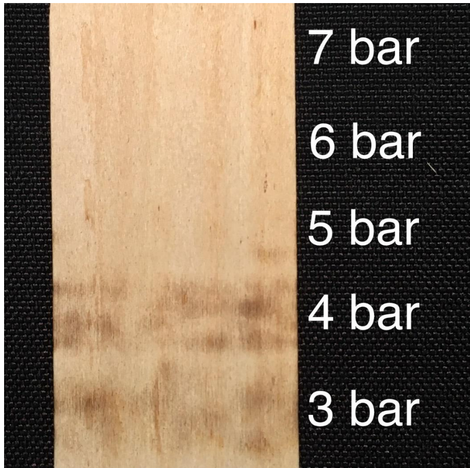
Fig. 4.58 Trattamento su legno LM, ugello circolare 4 mm, differenti pressioni d'aria compressa
