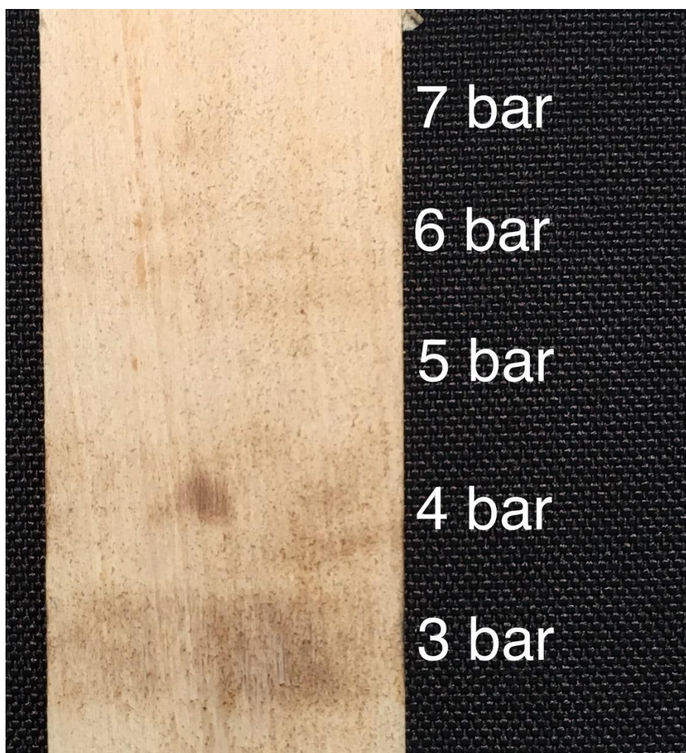
Fig. 4.61 Trattamento su legno LM, ugello circolare 6 mm, differenti pressioni d'aria compressa
