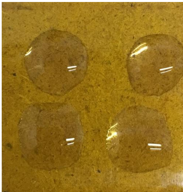
Fig. 4.49 Trattamento su kapton, ugello circolare 2 mm, pressione d'aria compressa =7 bar, subito dopo il trattamento
