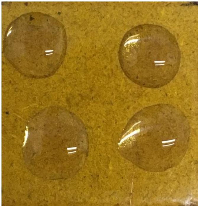
Fig. 4.51 Trattamento su kapton, ugello circolare 2 mm, pressione d'aria compressa =7 bar, 3 minuti dopo il trattamento
