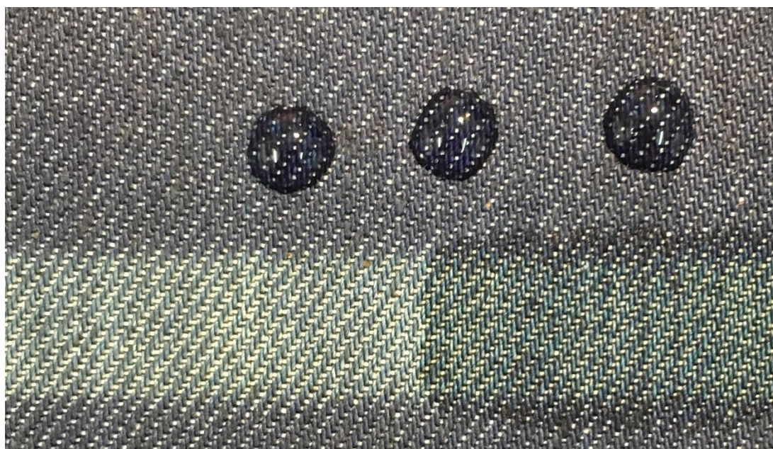
Fig. 4.33 Tessuto denim, ugello circolare 2 mm, pressione d'aria compressa 7 bar, trattamento ottimizzato
