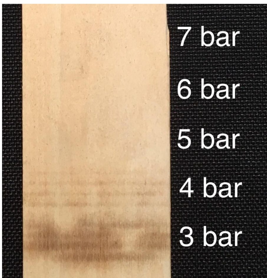
Fig. 4.59 Trattamento su legno LM, ugello lineare, differenti pressioni d'aria compressa
