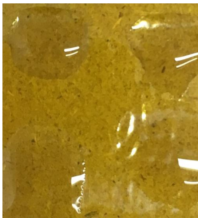
Fig. 4.50 Trattamento su kapton, ugello circolare 2 mm, pressione d'aria compressa =3 bar, subito dopo il trattamento
