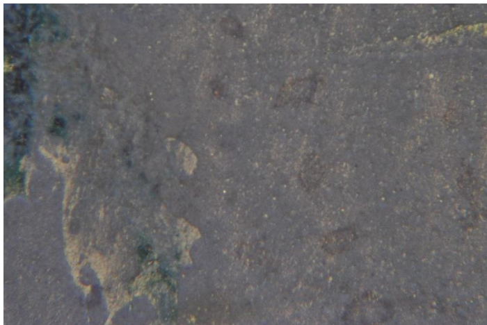
Fig. 4.14 Acciaio pre-verniciato (stessa zona) trattato al plasma e successivamente lavato con l'acqua
