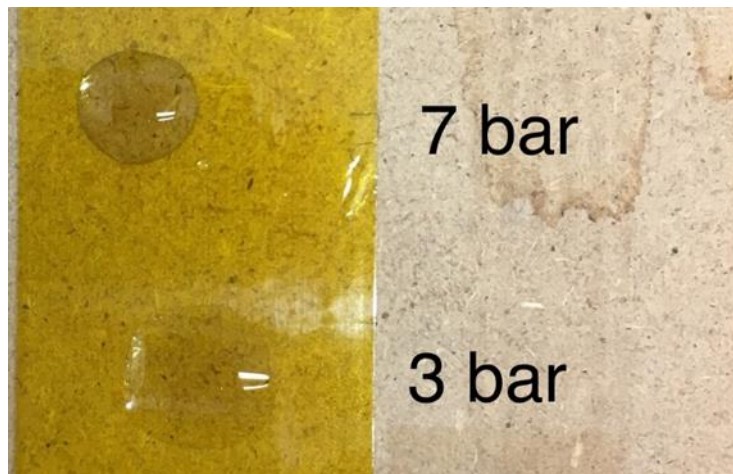
Fig. 4.48 Trattamento su kapton, ugello circolare 2 mm, differenti pressioni d'aria compressa
