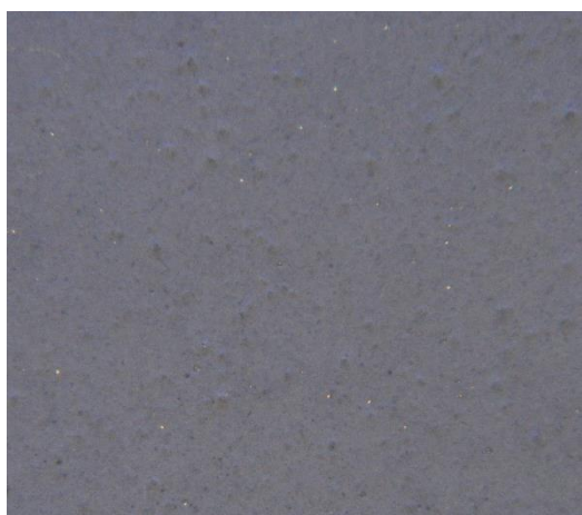
Fig. 4.13 Acciaio pre-verniciato (stessa zona) trattato al plasma (area immagine ca. 0.75 mm x 1 mm, ingrandimento 5x)
