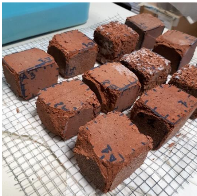
Figura 2.66 Foto dei provini al 9 °ciclo della prova di cristallizzazione di sali.
