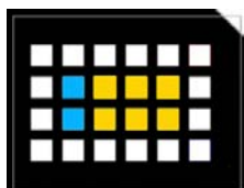
Figura 5.13: Funzionalizzazione con PEG 3400 Da 1 mM nei pozzetti gialli, esposizione a milliQ nei pozzetti azzurri
