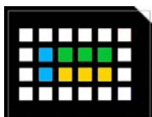
Figura 5.14: In verde i pozzetti funzionalizzati con PEG 3400 Da che verranno attivati per l'immobilizzazione dell'anticorpo, in giallo i pozzetti funzionalizzati solamente con PEG 3400 Da 1 mM
