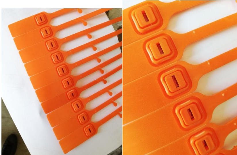
Fig. 5 Sigilli di sicurezza con ingrandimento difetti
