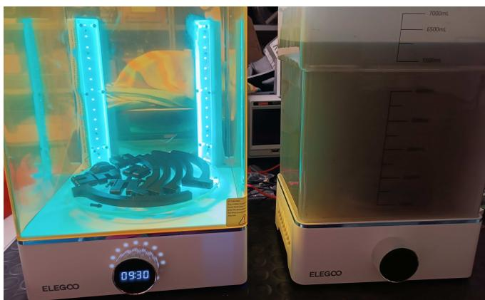
Figura 3.14: Operazioni di pulizia e completamento del processo di polimerizzazione della resina
