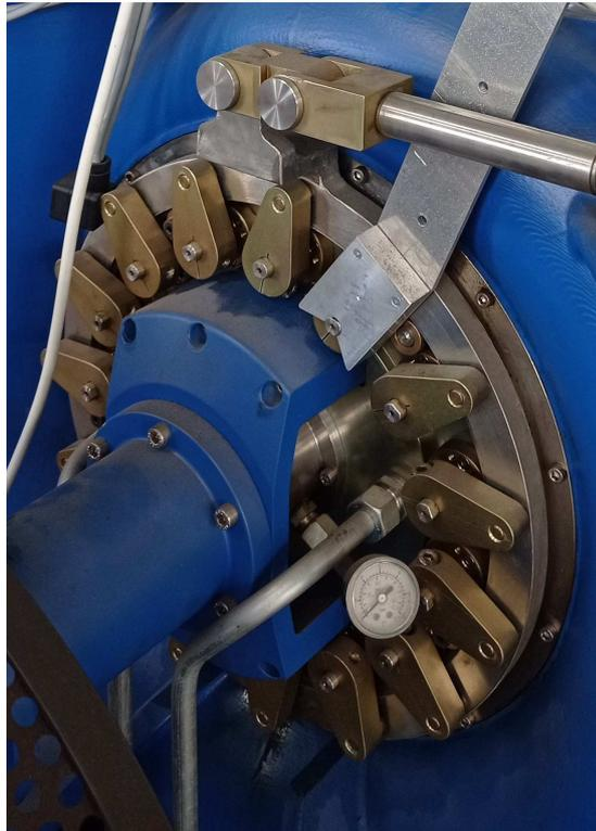
Figura 1.15: Sistema regolazione apertura pale direttrici, Laboratorio macchine idrauliche Univeristà degli studi di Padova.
