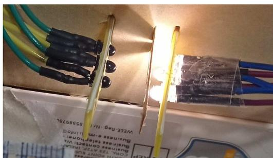
Figura 4.2: Prototipo encoder assoluto sperimentale
