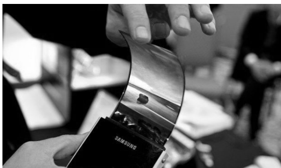
Figura 2.1: Un prototipo di display flessibile basato su OLED.
