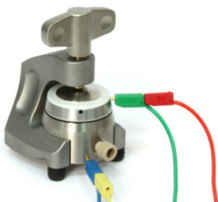
Figura 2.1: Struttura a) compatta e b) espansa che evidenzia i vari componenti di una EL-CELL® modello ECC-Std. Figura tratta da: 74
